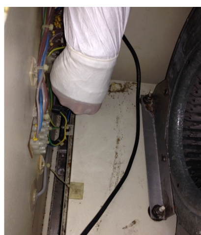
Foto D Tampone interno vano motore su viti
