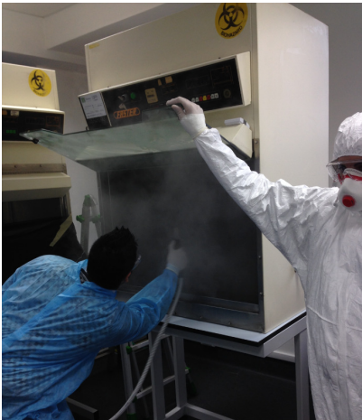
Foto E Decontaminazione mediante strumento Hygienio
