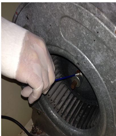
Foto C Tampone interno vano motore perno
